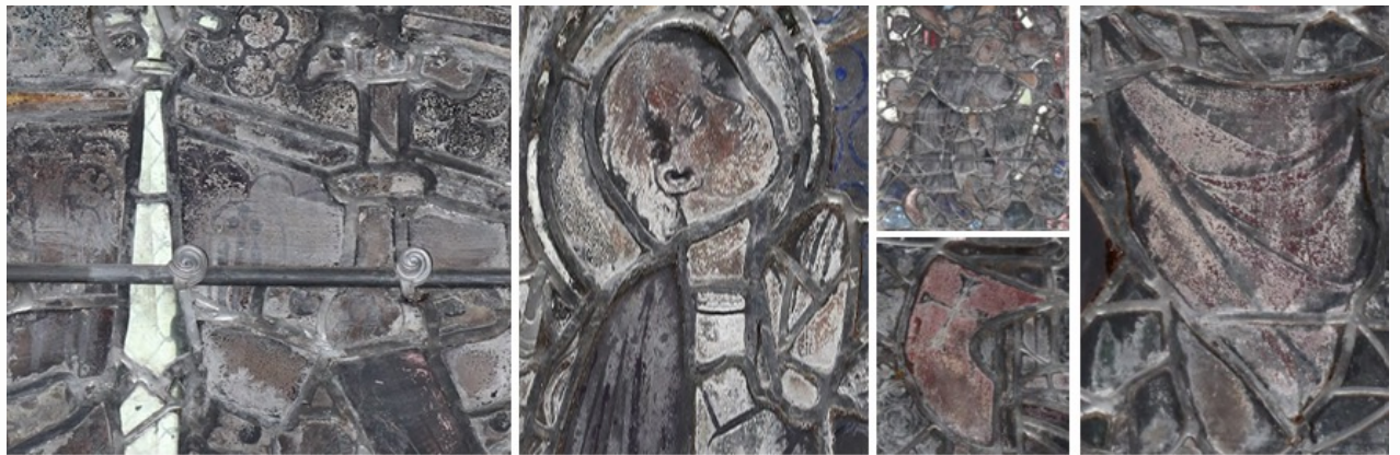
Altération des verres anciens par piqûres. Produits d'altération blanchâtres en fond de cratère. La surface du verre est attaquée par l'eau de condensation par exemple. Au-dessus de cette altération, sur la première photo, on observe une sorte de « couverture » à froid très adhérente. Des traces de pinceaux sont visibles.
